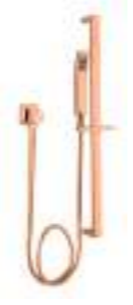
Ref. RB81510 Acabamento rose gold [5091]. Flexível de metal de 1,5 metros. Ducha de barra para box e banheira com regulagem. Vazão: 8 l/min com 15 m.c.a. Pressão recomendada: de 15 m.c.a. até 40 m.c.a.
